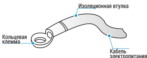
Если нет возможности обжать кольцевые клеммы из-за ограниченного пространства на месте, необходимо подсоединить кабели электропитания с одинаковым сечением жилы с обеих сторон клеммы питания внутреннего блока (см. рис. ниже).
