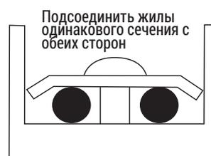
Запрещено зажимать кабели электропитания с жилами одинакового сечения с одной и той же стороны клеммы, также запрещено использовать два кабеля электропитания с жилами разного сечения на одной и той же клемме. В противном случае это может привести к ослаблению соединения из-за неравномерного обжатия, что приведет к аварийным ситуациям.
