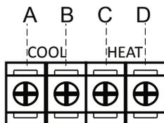
Примечание: терминала В и D подключены как один отрицательный (-), поэтому возможны 3 провода в кабеле для управления охлаждением / обогревом.
